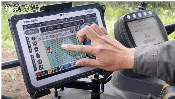
無人での作業を行う設定している様子
